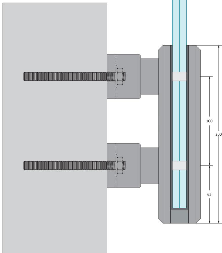
■ Σύστημα κάθετης στήριξης υαλοπίνακα με ιδιαίτερο χαρακτηριστικό τον εμπλουτισμό της ανεμπόδιστης θέας και την παροχή μεγάλων επιφανειών σε έργα & κτίρια υψηλού επιπέδου. Αίσθηση σταθερότητας και αντοχής με την πρώτη εικόνα.
